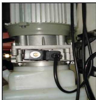
Figure 15 (vanne de descente)
